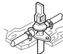
Pour le chauffage Trumatic C, la soupape FrostControl remplace la soupape de sûreté/de vidange électrique ELASI.
