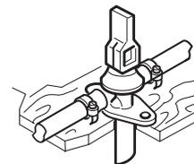
Nella stufa Trumatic C, FrostControl sostituisce la valvola di scarico di sicurezza ad azionamento elettrico ELASI.
