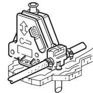
**!** Um ein sicheres Abfließen des Boilerinhalts bei Frostgefahr zu ermöglichen, muss am Warmwassersanschluss des Boilers ein automatisches Belüftungsventil montiert sein. Serienmäßig bei allen Warmwassergeräten von Truma.
