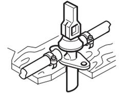
En la calefacción Trumatic C, el FrostControl sustituye la válvula de seguridad/purga eléctrica ELASI.
