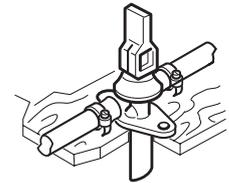
Bei der Heizung Trumatic C ersetzt das FrostControl das elektrisch betätigte Sicherheits-/Ablassventil ELASI.
