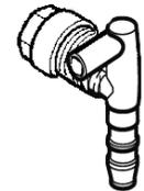
Efectuar el desagüe directamente hacia el exterior, en una zona protegida contra las salpicaduras de agua (colocar una protección contra salpicaduras en caso necesario).
