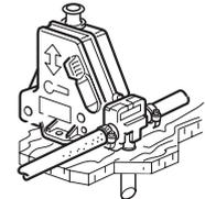
**!** Om een veilig leegstromen van de boilerinhoud bij vorstgevaar mogelijk te maken, moet aan de warmwateraansluiting van de boiler een automatisch ventilatieventiel gemonteerd zijn. Standaard bij alle warmwatertoestellen van Truma.
