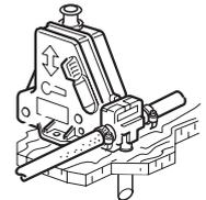
**!** Para permitir que el contenido del calentador se evacúe de forma segura en caso de peligro de heladas, en la conexión de agua caliente del calentador debe montarse una válvula de aireación automática (de serie en todos los calentadores de agua Truma).
